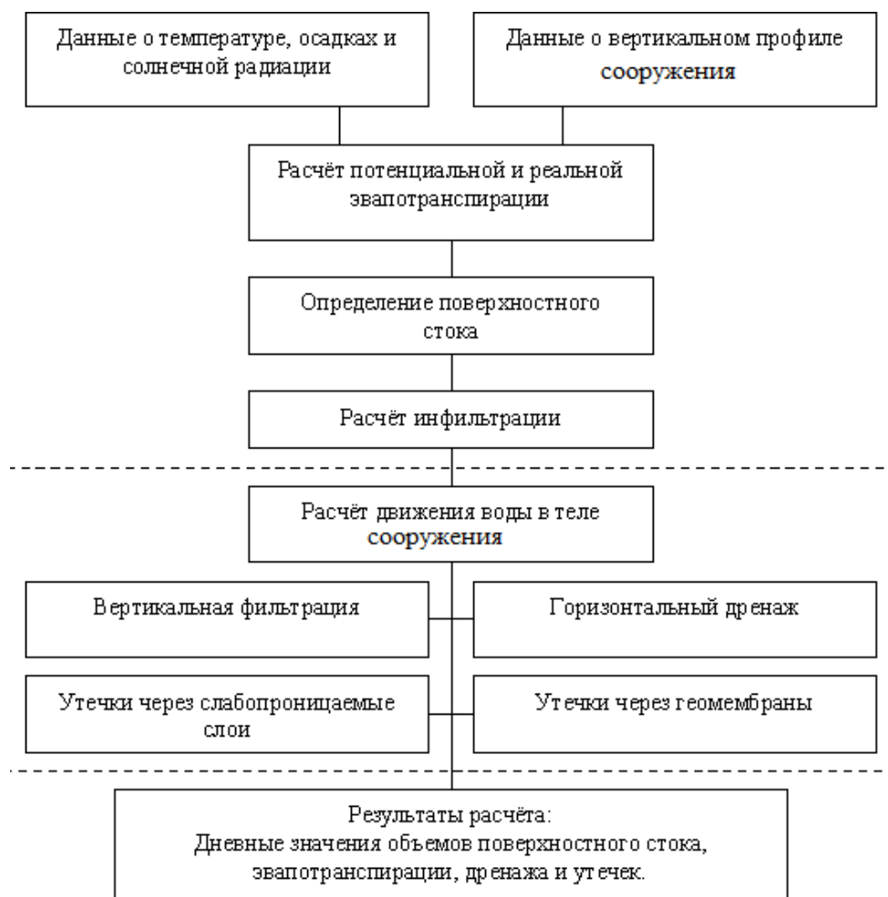
Рис. 1. Блок- схема расчёта водного баланса сооружения
